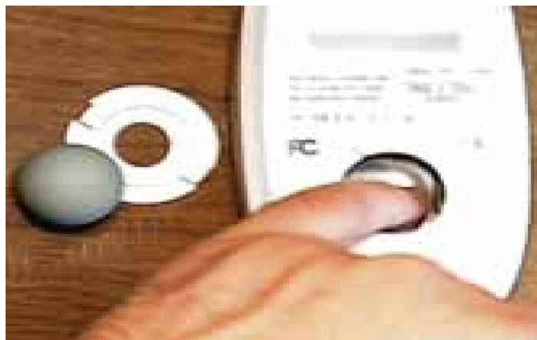
Gambar 12. Prosedur Membuka Mouse (Lanjutan)
