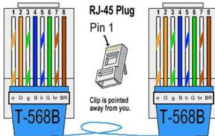
Dari gambar diatas, maka kita dapat melihat bagaimana susunan kabel untuk jenis straight. Tinggal anda susun kabel berdasarkan urutan warna pada gambar untuk konektor 1 dan 2.
